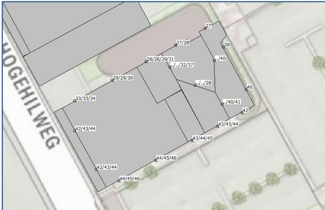
Afbeelding 10. Geluidbelastingen L_{day} (incl. aftrek art. 110g Wgh) Karspeldreef Berekende geluidbelastingen op een hoogte van 1,5 meter boven de vloer
