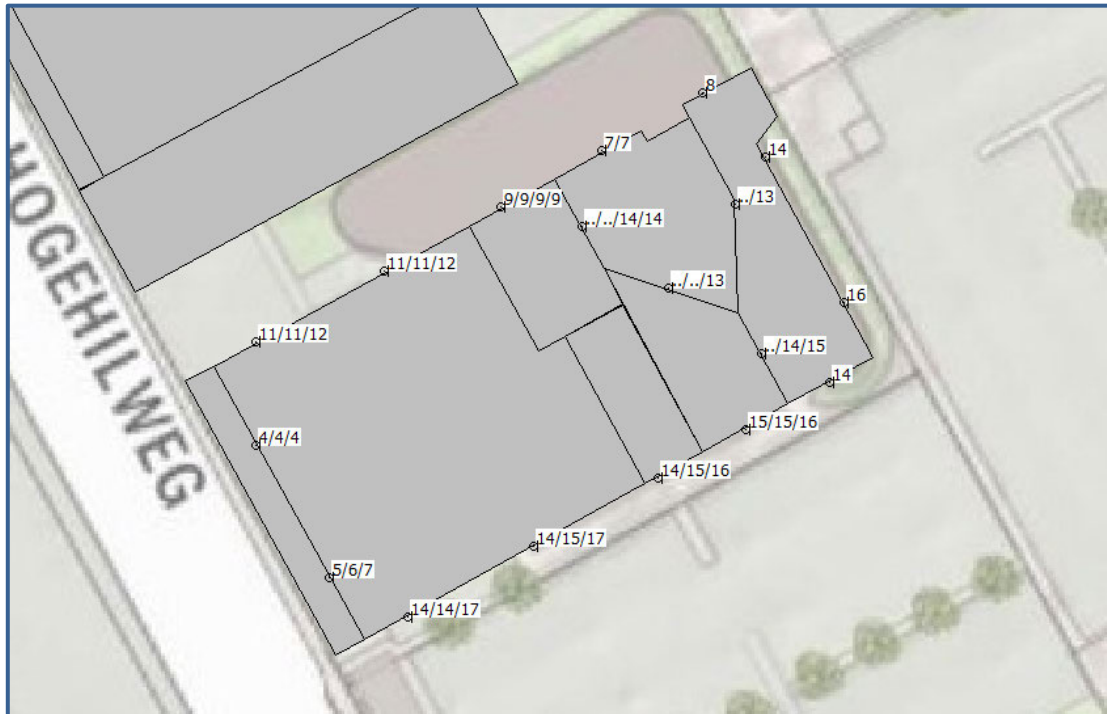
Afbeelding 11. Geluidbelastingen L_{day} (incl. aftrek art. 110g Wgh) Hullenbergweg Berekende geluidbelastingen op een hoogte van 1,5 meter boven de vloer
