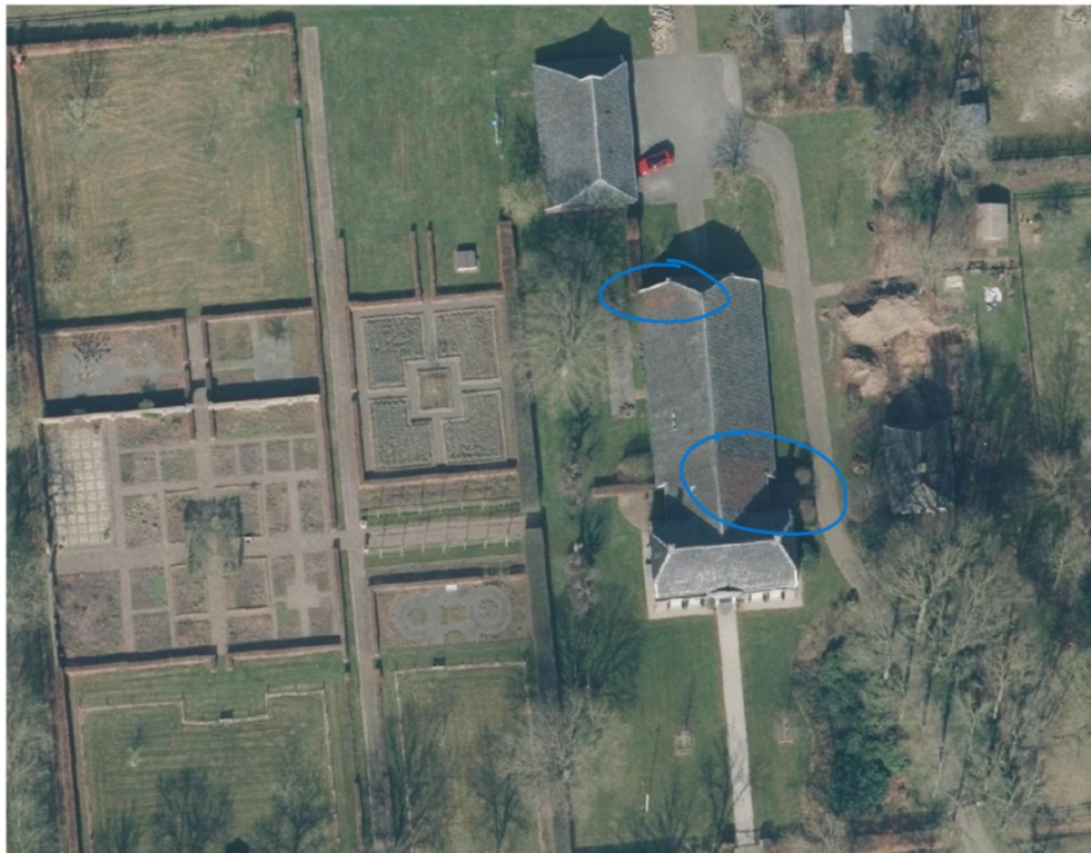
Luchtfoto Duidelijk te zien zijn de 2 dakvlakken waar een rode pan is gebruikt ter vervanging.
