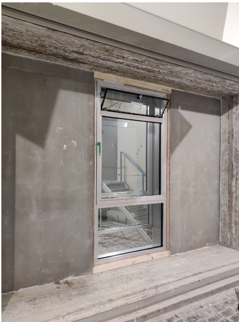
Figuur 3.1: Meetopstelling zoals waargenomen vanaf de binnenzijde, hier weergegeven de 1250x2500 mm variant
