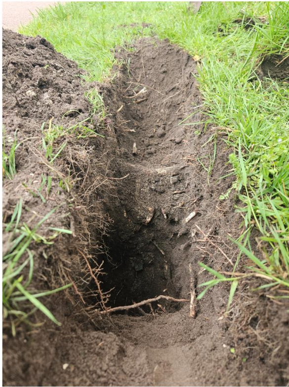
Figuur 14: Zij aanzicht van de profielsleuf uit het groeiplaats onderzoek.
